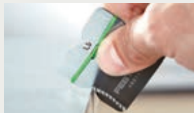
Trimis integruotais skirtingo spindulio ašmenimis galite ne tik išlyginti nufrezuotas briaunas, bet ir suapvalinti plonos laminavimo juostos briaunas.
